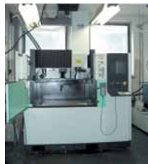
Technologie elektroerovizního obrábění zakoupená společností MouldPro s.r.o. zlínský podnikatel.
